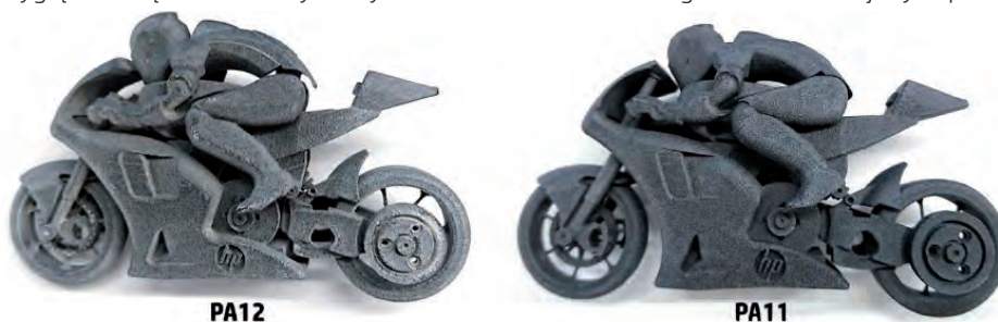
Rycina 1. Wygląd i wrażenia dotykowe dwóch identycznych części drukowanych w profilu zrównoważonym z HP PA 12 (po lewej) i mechanicznym z HP PA 11 (po prawej)
