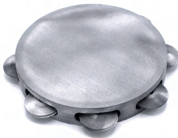
Rycina 3: Można też tworzyć w drukarkach 3D membrany perkusyjne, np. do tambury. Wydrukowanie tambury membranę do dołu pod kątem 30 stopni pozwala uniknąć wypaczenia membrany
