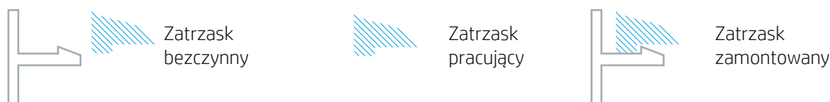
Rycina 2. Montaż zatrzasku wspornikowego
