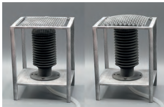
Rycina 11: Urządzenie pneumatyczne z drukarki 3D
