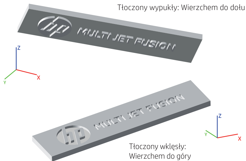
Rycina 1. Zalecane ukierunkowanie tekstu tłoczonego wypukłego (wierzchem do dołu) i wklęsłego (wierzchem do góry) na częściach HP Multi Jet Fusion
