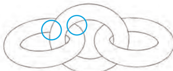
Rycina 2: Zapewnić wystarczające odstępy, by nie dopuścić do przypadkowego zespojenia
