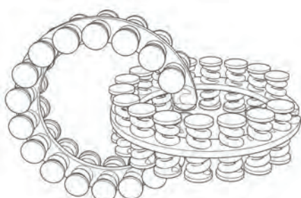
Rycina 6: Te pierścienie mają sprężyny, ale i otwory umożliwiające ich przekonfigurowanie
