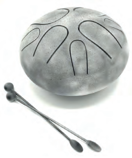
Rycina 2: Duże, wydrążone części o względnie cienkich ścianach i z otworami będą rezonować. W powyższym przykładzie wycięcie „języczków” w bębnie działa jak dodanie wsporników. Ich ton jest funkcją masy wspornika, a zatem zależy od jego grubości, długości, kształtu i przekroju.
