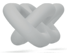
Rycina 9: Ogniwia łańcucha ukierunkowane pod kątem -45 i +45 stopni do formy drukarskiej
