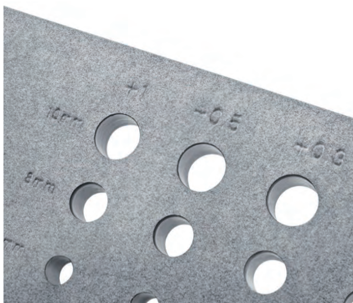
Rycina 2: Testowanie wstępnego otworu HP MJF
