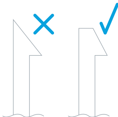
Rycina 17. Zgrubienie zatrzasku
