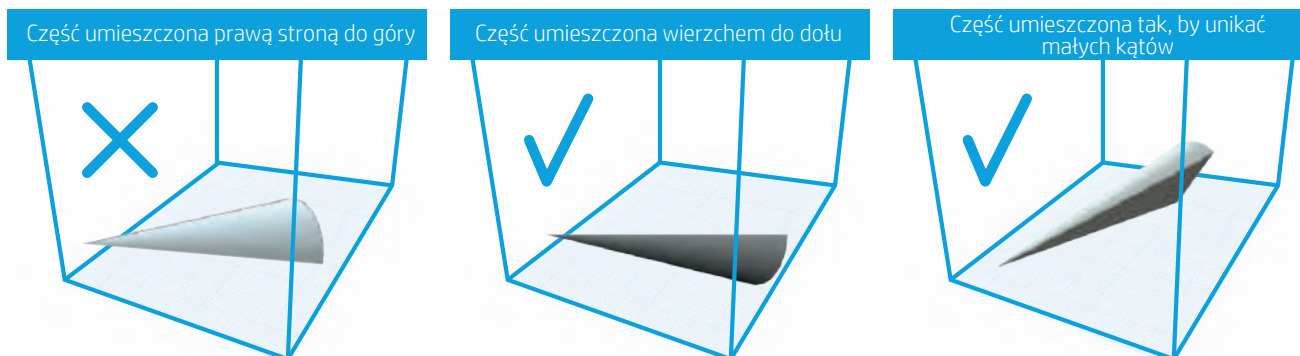
Rycina 2. Strategie ukierunkowania dla części z zakrzywionymi powierzchniami pozwalające zminimalizować nadmierną dyskretyzację warstw w wyglądzie
